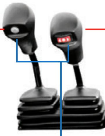
Boutons de coupure de transmission affectant toute la puissance moteur sur les performances hydrauliques.
