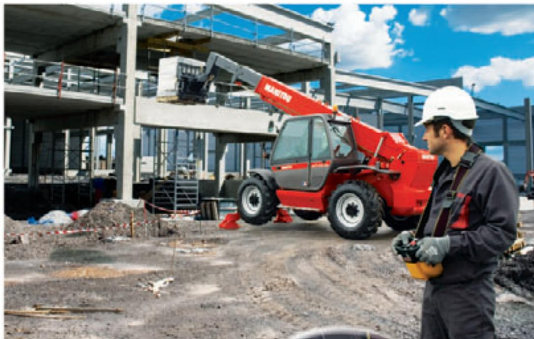
L'option Radio commande permet de commander les mouvements du télescope à distance et faciliter ainsi le placement de vos charges.
