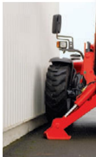
Les stabilisateurs étroits ne dépassent pas de la largeur de la machine et peuvent ainsi être posés au sol même sur les chantiers les plus étroits.
